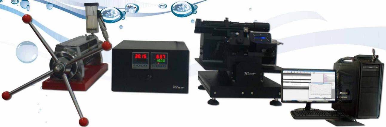
高温高压旋转滴界面张力仪TX500HP型是专门针对超高压和高温条件下测试界面张力（油水或油-水-液化气界面张力）以及表面张力（油-气）而设计。本仪器的最高压力可达100MPa，测试温度范围为-10-200℃，可广泛应用于测试随着压力和温度变化的而变化的界面化学物性测试，特别适用于油田三次采油时模拟井下作业实际环境中高压、高温条件下的原油与三元、二元液的界面张力以及原油与驱油剂-液化气之间的界面张力测试。本仪器可测得的最低油-水界面张力值可达 $10^{-7}$ mN/m。同时，配合专门的气氛接口，可分析在不同压力和温度条件下的液-液-气界面张力值，如表面活性剂水溶液、原油和二氧化碳或天然气的界面张力值。
